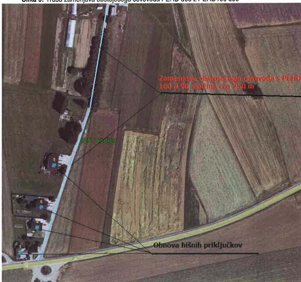
Slika 3: Trasa zamenjava obstoječega cevovoda PEHD d63 z PEHD100 d90
